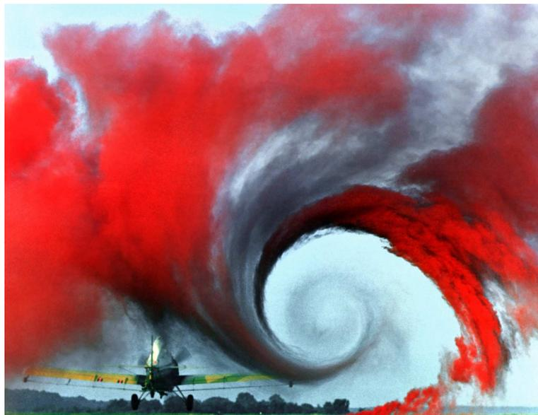
Grâce aux ordinateurs, la complexité des équations de la mécanique des fluides a permis de comprendre comment se forment les vortex et ainsi de modifier l'extrémité des ailes d'avion pour diminuer leur traînée.
