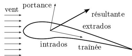
pale d'une éolienne se comporte comme une aile d'avion. Il se crée autour d'elle un écoulement de l'air qui aboutit à une diminution de la pression sur l'extrados, la partie supérieure de l'aile, et une augmentation sur l'intrados, la partie inférieure. Le résultat est qu'une force, de portance dans le cas d'un avion ou de traction dans le cas d'une éolienne, apparaît comme le montre la figure 7.7.
