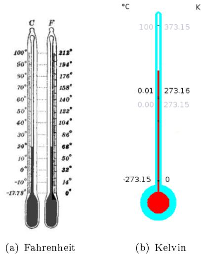
FIGURE 9.1 – Les échelles de température<sup>83</sup>
