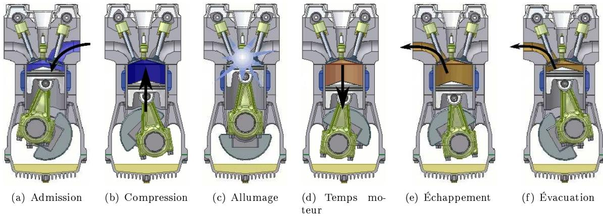
FIGURE 10.13 – Moteur à explosion<sup>87</sup>
