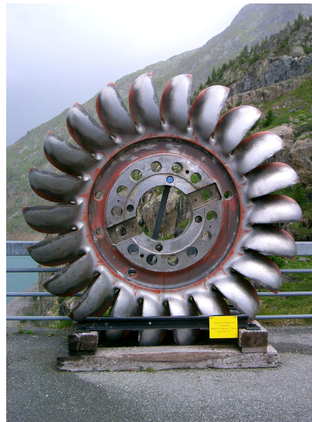
FIGURE 7.5 – Ancienne turbine Pelton Barrage d'Emosson, centrale de Châtelard 43 850 kW, 500 tr min, 7135 kg en acier inox.
