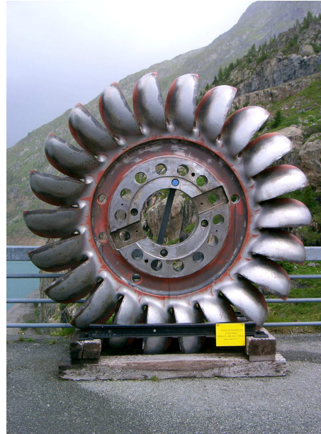
Figure 7.5 – Ancienne turbine Pelton Barrage d'Emosson, centrale de Châtelard 43'850 kW, 500 t/min, 7135 kg en acier inox.
