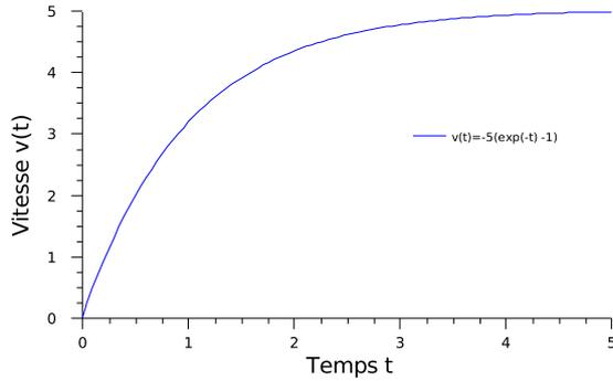
FIGURE 5.2 – Chute dans un fluide visqueux
