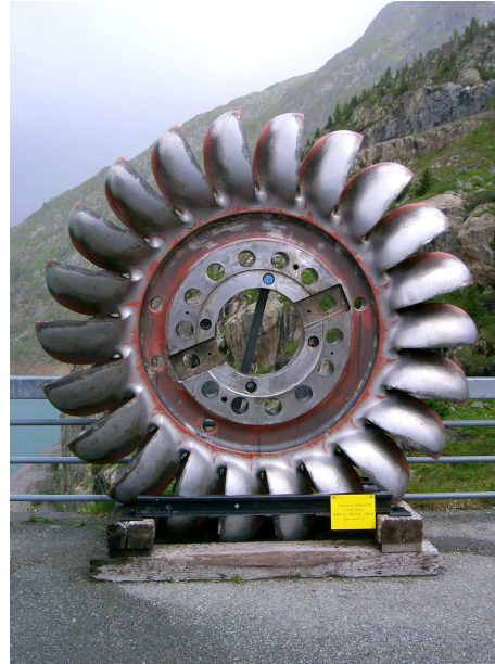
Figure 7.5 – Ancienne turbine Pelton Barrage d'Emosson, centrale de Châtellard 43 850 kW, 500 tr min, 7135 kg en acier inox.
