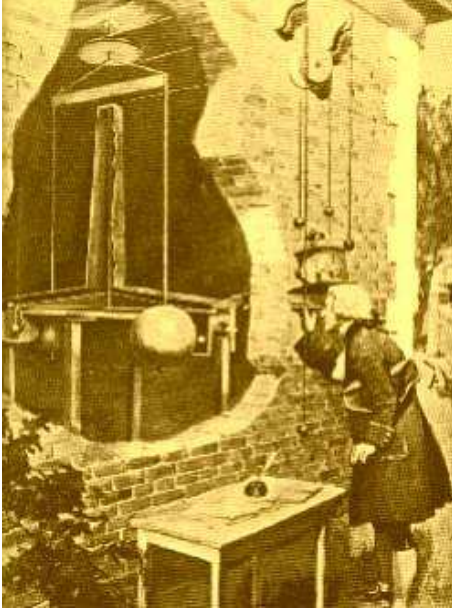
Figure 3.1 – La balance de Cavendish Mesurer la force de gravitation 59
