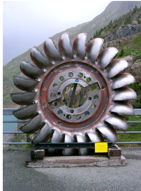
FIGURE 4.5 – Ancienne turbine Pelton Barrage d'Emosson, centrale de Châtillard 43'850 kW, 500 t/min, 7135 kg en acier inox.
