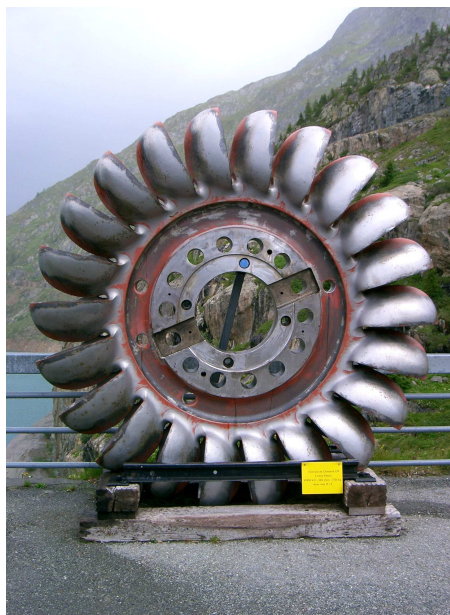
Figure 7.5 – Ancienne turbine Pelton Barrage d'Emosson, centrale de Châtillard 43'850 kW, 500 t/min, 7135 kg en acier inox.
