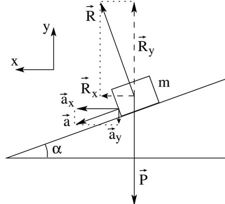
Ce qui change, c'est que l'accélération aussi doit être décomposée. En effet, aucune des deux composantes n'est maintenant nulle. Ainsi, les équations du mouvement deviennent (en tenant compte des signes) :
