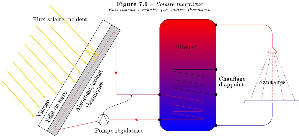
**Figure 7.9 – Solaire thermique**
