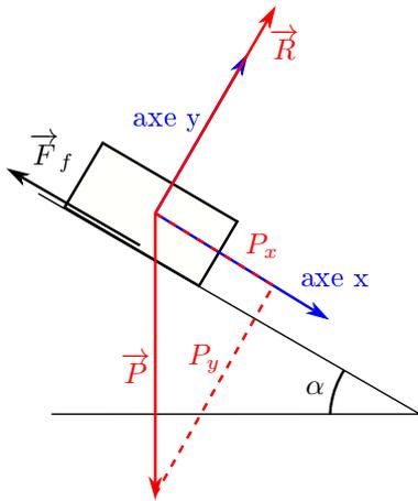
le système d'axe de cette figure, les équations du mouvement sont :
