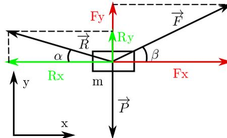
En considérant que le poids  $P = m \cdot g$  et les triangles d'angles au sommet  $\alpha$  et  $\beta$ , grâce à la trigonométrie, on peut écrire :
