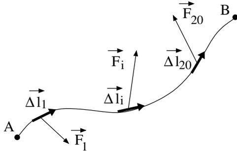
Ainsi, pour déterminer le travail total effectué par la force sur le chemin A-B, il faut décomposer ce dernier en petits bouts de déplacement rectilignes  $\vec{\Delta l}_i$ , sur lesquels la force peut être considérée comme vectoriellement constante (c'est-à-dire qu'elle ne change ni en direction, ni en sens, ni en grandeurs). On est ainsi ramené au calcul d'un petit élément de travail  $A_i$ , pour une force  $\vec{F}_i$  constante, sur un déplacement  $\vec{\Delta l}_i$  :
