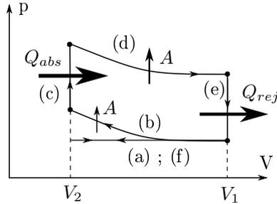
La différence constitue le travail fourni par le système pendant le cycle, une partie étant produite par le gaz pendant le temps moteur et une autre absorbée par celui-ci pendant la compression. Attention,  $Q_{rej} > 0$  et il faut donc soit additionner les deux chaleurs pour avoir le travail qui constitue leur différence ou soustraire l'opposé de la chaleur rejetée, soit  $|Q_{rej}| = n \cdot C_V \cdot (T_4 - T_1)$ . On a donc :
