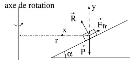
Si  $\alpha > \arctan(\mu_s)$ , il est nécessaire qu'il y ait une vitesse pour ne pas glisser. En effet, en décomposant la seconde loi de Newton sur les axes  $x$  et  $y$  de la figure 4.9, on a :
