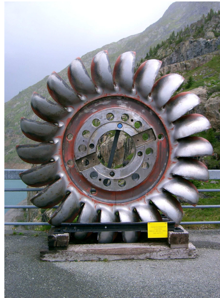
FIGURE 7.5 – Ancienne turbine Pelton Barrage d'Emosson, centrale de Châtelard 43'850 \text{ kW} , 500 \text{ t}/\text{min} , 7135 \text{ kg} en acier inox.
