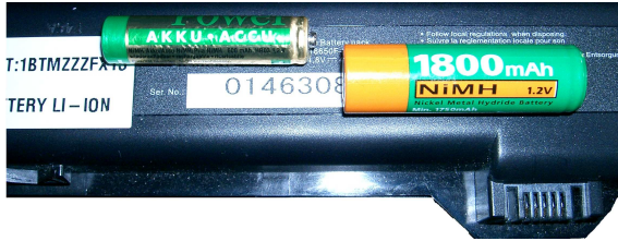
FIGURE 3.10 – Accumulateurs Ni-MH et lithium-ion
