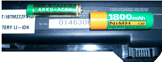
FIGURE 3.10 – Accumulateurs Ni-MH et lithium-ion
