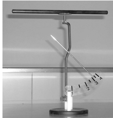
FIGURE 2.1 – L'électroscope et le bâton chargé.
