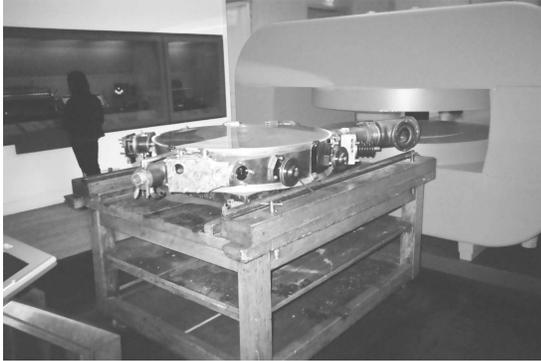
FIGURE 4.19 – Les deux D d'un cyclotron
