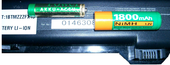
FIGURE 3.10 – Accumulateurs Ni-MH et lithium-ion
