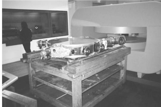
FIGURE 4.20 – Les deux D d'un cyclotron
