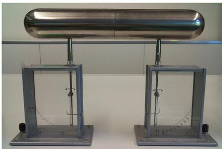
guille ont donc la même charge acquise par contact. Cette charge reste sur l'électroscope et peut augmenter si on amène des charges avec un autre bâton chargé.
