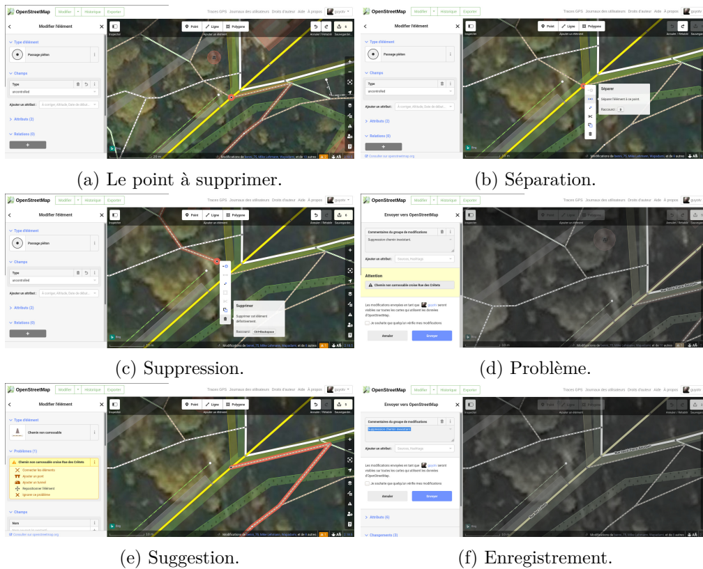
FIGURE 51 – Suppression de l'extrémité d'un segment
